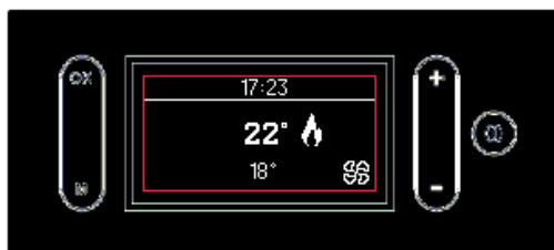
Accès avec thermostat Off (Stand by Off)
